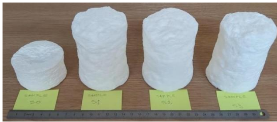
Figura 3.8 Un set de probe utilizate pentru investigațiile acustice [187]
