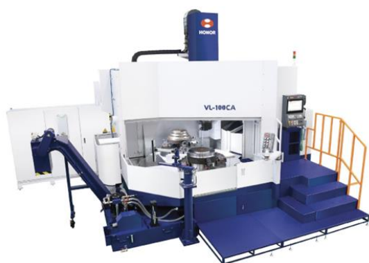
Figura 1.4. Strung vertical VL-100CA (Fotografie realizată de: Honor Seiki) – © 2001 - 2026 Copyright. MM Industrial Spectrum. [7]
