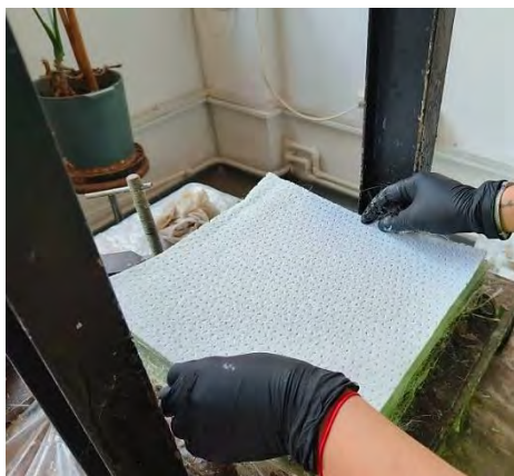
Figura 4.6 Așezarea straturilor unul peste altul (Coremat)
