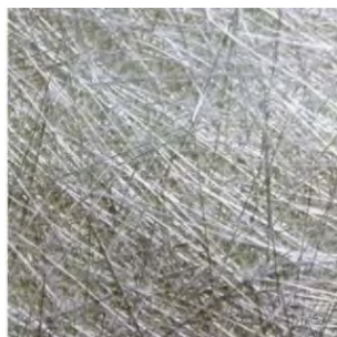
a) Tort presat din fibre de sticlă E, tăiate, 450 g/m 2 (CSM)
