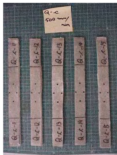
Figura 4.15 Exemplu de marcarea probelor pentru folosirea extensometrului optic
