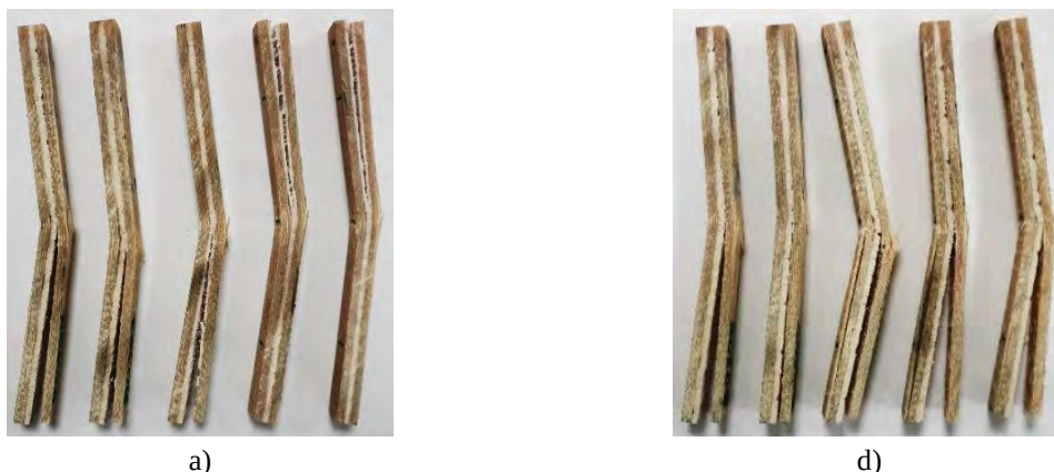
Figura 4.19 Eșantioane testate la încovoiere în trei puncte, material QM-g: a) 10 mm/min, d) 1000 mm/min – lateral
