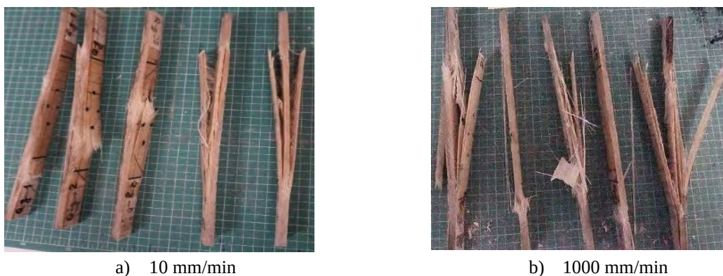
Figura 5.42 Eșantioane testate la tracțiune
