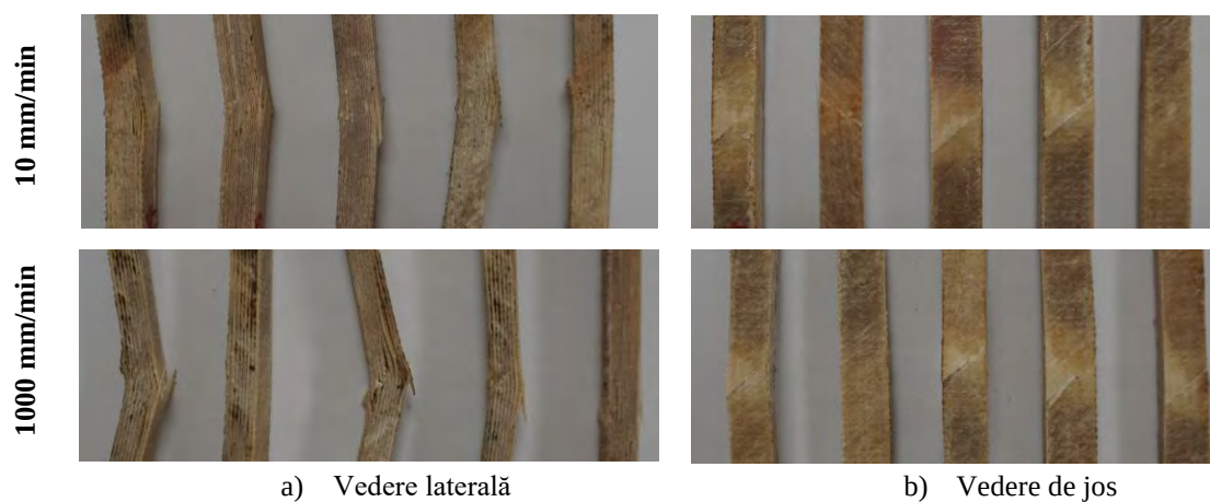
Figura 5.41 Eșantioane testate la încovoiere în 3 puncte
