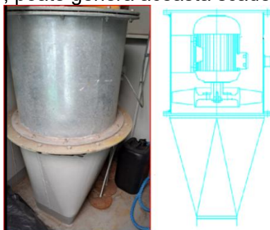
Figura 3.10 Remorcherul Fluvial - Ventilația compartimentului mașini – Reducție instalată pe refularea ventilatorului
