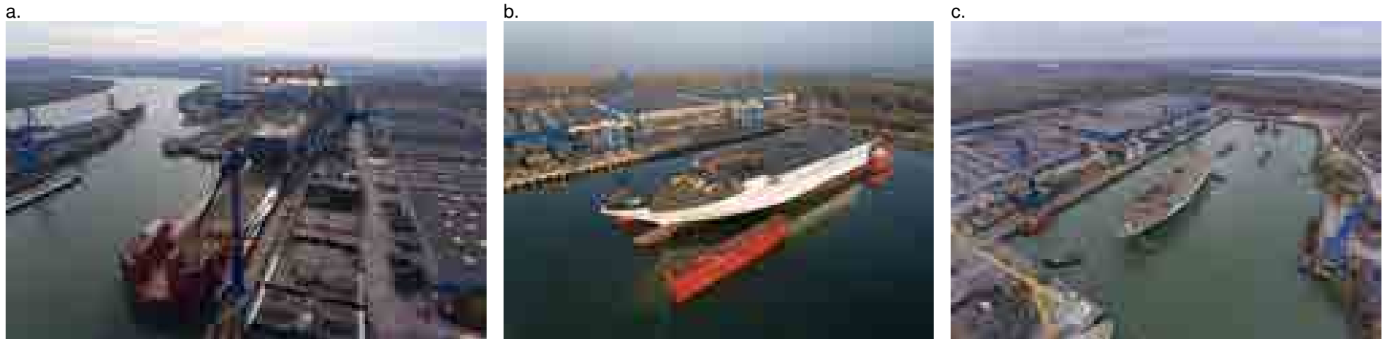
Figura 4.30.a., b., c.. Andocarea de pe cheu pe puntea docului a unei nave și lansarea acesteia în acvatoriul portului [74], [75], [76]
