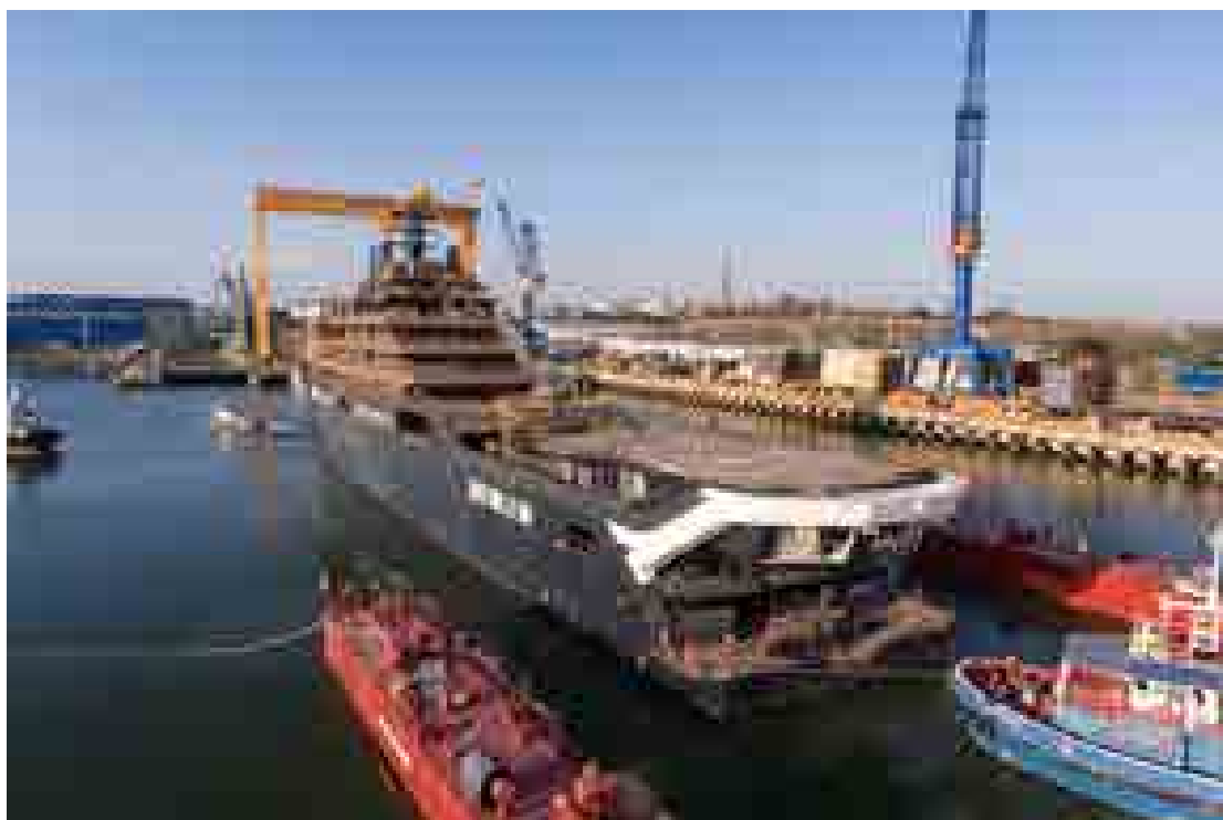
Figura 1.5. Docul plutitor Dock_VARD_Tulcea balastat maxim pentru realizarea tractării cu ajutorul pilotinelor a navei în curs de lansare [15]
