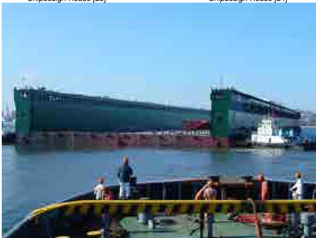
Figura. 1.10. Docul plutitor S.N. Geoje, Coreea de Sud (430mx84mx23,5m – 20800t) [25]
