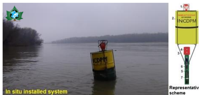
Figură 29 Stația DKTB de monitorizare a ihtiofaunei și în special a sturionilor, prin teledetecție cu marcă ultrasonică, în diferite condiții hidrologice (Deak, Badilita, et al. 2012)
