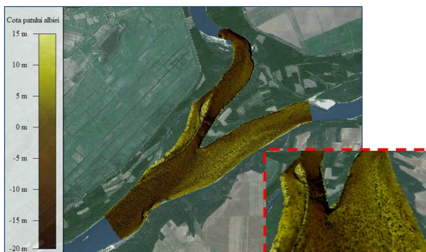
Figură 44 Relieful patului albiei rezultat în urma măsurătorilor batimetrice multibeam efectuate în anul VII de analiză. Detaliu zona de bifurcație
