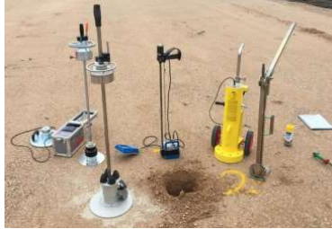
Fig. 2.2 Dispozitive uzuale pentru măsurători in situ ale proprietăților terenului cu: deflectometru cu greutate mică, penetrometru conic dinamic, ciocan Clegg, placă pentru testare
